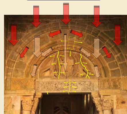
Désordres structurels constatés résultant de la répartition des charges
