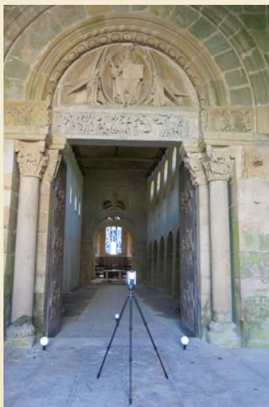
Laser rotatif et plots de triangulation en opération de numérisation 3D
